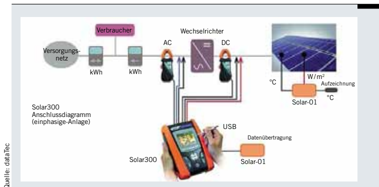
Bild 6: Anschlussdiagramm zum Erfassen des Wirkungsgrads
