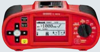
Bild 7: Zur Prüfung der allgemeinen elektrischen Sicherheit eignen sich Messgeräte wie z. B. iT120B von Benning oder Profitest M-Tech von Gossen Metrawatt
