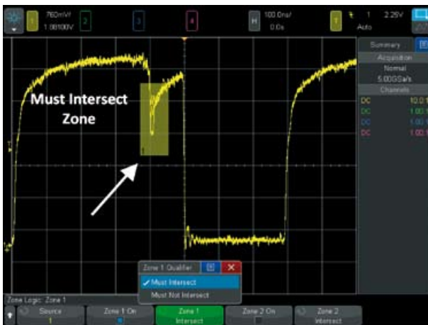
Bild 5: Ein selten auftretender metastabiler Zustand lässt sich mit dem Zonentrigger isolieren.
