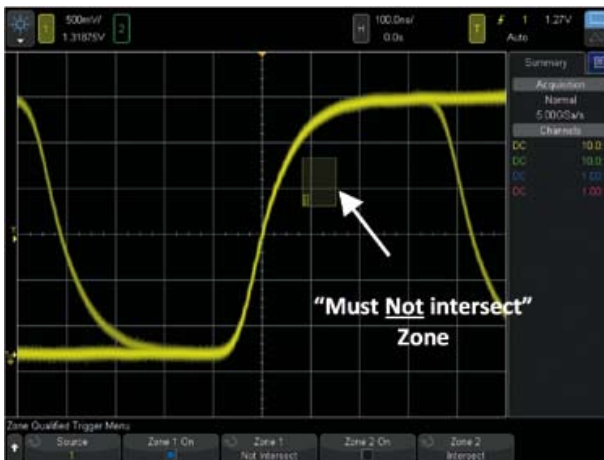
Bild 3: Erfassen und Darstellen ausschließlich von Signalen mit »normalen« Flanken mit dem Zonentrigger.
