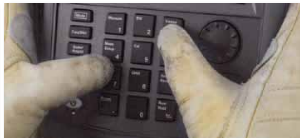
Bild 3: Die Knöpfe des Geräts sind so groß, dass man sie auch mit Handschuhen bedienen kann.
