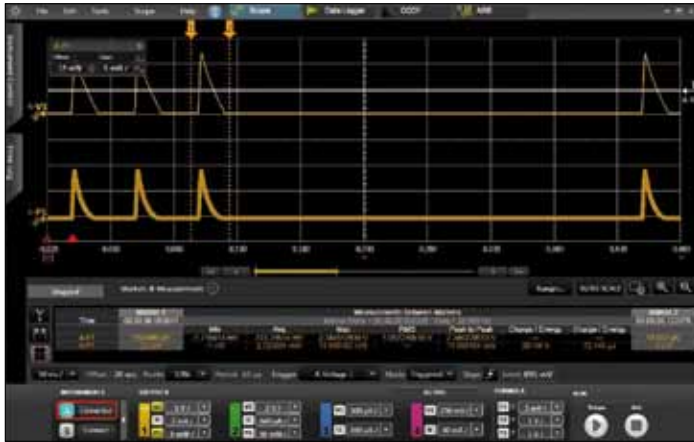
Bild 6. Der Arbiträrsignalgenerator in der SMU N6781A kann zur Simulation eines Energy Harvester eingesetzt werden – hier z.B., um die Spannungsimpulse eines manuell betätigten elektrodynamischen Wandlers zu erzeugen.
