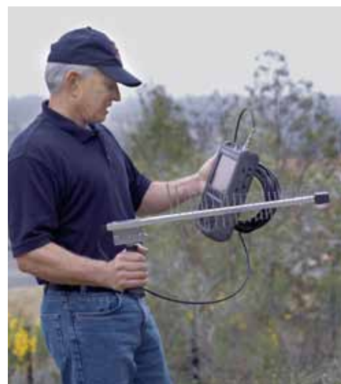
Bild 1. Ein tragbarer, robuster Netzwerk-, Spektrum- oder Kabelanalysator bis 26,5 GHz von Agilent bietet im rauen Feldeinsatz die Genauigkeit wie ein entsprechendes Labormessgerät. (Fotos: Agilent)
