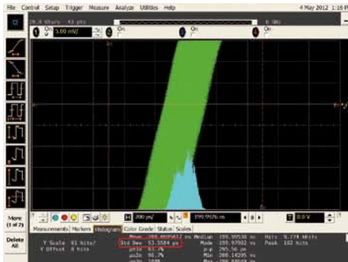
Bild 4. Jitter-Messung an einem DDS-generierten Signal. Zu erkennen ist im Vergleich zu Bild 3 im blau gefärbten Histogramm unten die „breitere“ Anstiegs-Flanken-Zeitvarianz.
