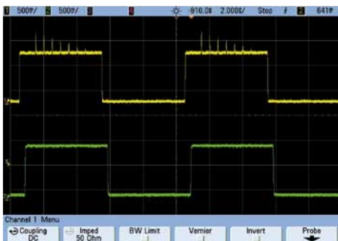
Bild 6. Arbiträrsignalvergleich bei 100 kHz. Die gelbe Kurve zeigt das Trueform-Signal und die grüne das DDS-Signal.
