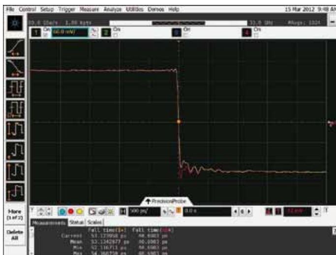
Bild 5. U_{\text{out}} (rot) und U_{\text{in}} (gelb) mit U_{\text{out}}/U_{\text{in}} -Kalibrierung.
