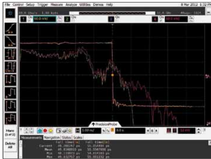
Bild 3. Zeit- und Frequenzantwort eines 6-GHz-Tastkopfs, auskorrigiert bis 12 GHz.
