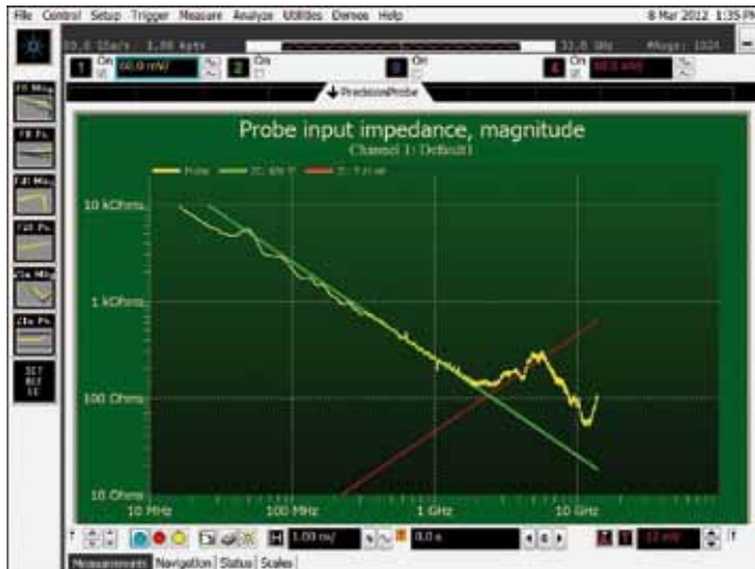
Bild 4. Die während der AC-Kalibrierung mit Precision Probe gemessene Eingangsimpedanz des Tastkopfs.
