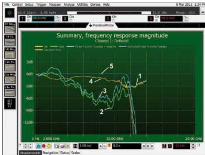
Bild 2. Ergebnisse der Tastkopf-Kalibrierung. Gelb (1) ist die am Eingang des Tastkopfes gemessene Spannung U_{in} ; sie wird größtenteils von orange überdeckt. Das zeigt, wie die Tastkopflast eine 50-Ω-Übertragungsleitung – das sind 25 Ω Quellimpedanz – beeinflusst. – Grün (2) ist die gemessene Ausgangsspannung U_{out} des Tastkopfes. – Zyan (3) ist die gemessene U_{out}/U_{in} -Übertragungsfunktion des Tastkopfes (grün dividiert durch gelb). – Orange (4) ist die korrigierte Ausgangsspannung des Tastkopfes. Sie wird die gemessene Eingangsspannung des Tastkopfes überdecken, wenn die U_{out}/U_{in} -Übertragungsfunktion einen linearen Frequenzgang bis hin zur durch Korrektur erreichbaren Grenzfrequenz aufweist. – Purpur (5) ist die korrigierte U_{out}/U_{in} -Übertragungsfunktion: Exakt so flach, wie sie sein soll.
