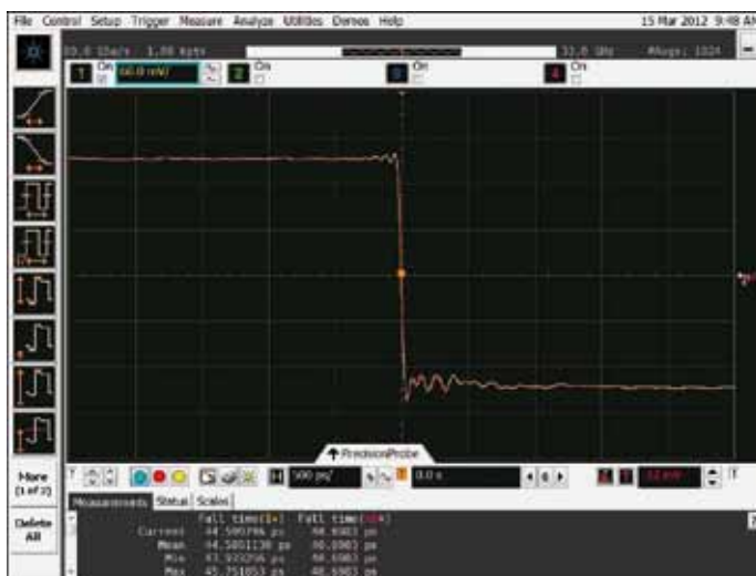
Bild 6. U_{\text{out}} (rot) und U_{\text{in}} (gelb) mit U_{\text{out}}/U_{\text{in}} -Kalibrierung auf der Basis einer in die Prüfspitze wirkenden Impedanz von 25 \Omega .
