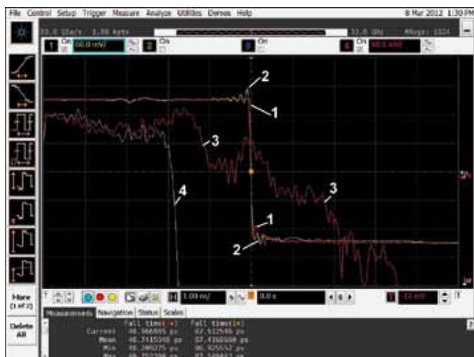
Bild 1. Sprungantwort eines 6-GHz-Differenzialtastkopfs im Zeit- und Frequenzbereich unter Verwendung nomineller Korrekturfaktoren. Die hier gezeigten Spektren entstehen durch Differenzieren der Sprungfunktionen, um die Impulsantworten zu erhalten, und eine anschließende schnelle Fouriertransformation der Impulsantworten, um den Frequenzgang zu errechnen. Erläuterungen: Die rote Rampe (1) liegt am Eingang des Tastkopfs, die gelbe Rampe (2) ist am Ausgang des Tastkopfs anliegend. Das rote Spektrum (3) ist am Eingang des Tastkopfs zu erfassen (alle Spektren haben vertikal 3 dB/Teilung, horizontal 2 GHz/Teilung), das gelbe Spektrum (4) ist am Ausgang des Tastkopfes festzustellen.
