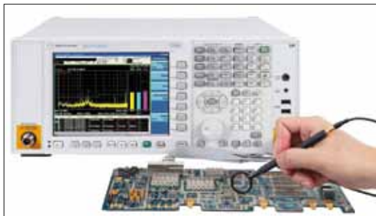
Bild 5. Fehlersuche mit einem „Closed Field“-Tastkopf.
